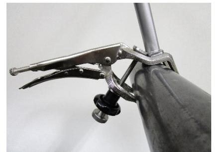
bis die Backen geklemmt sind – nun ist die Rohrzange vor Verdrehen gesichert
