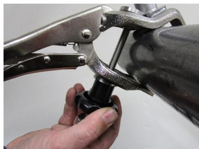
um die Feststellspindel wieder zu lösen, sollte die Rohrzange gespannt sein
