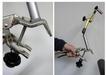
wenn das Handrad gelöst ist, kann die Rohrzange geöffnet werden
