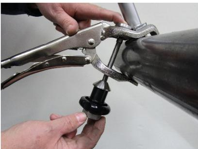
Gewindestange von unten einsetzen und mit dem Feststellrad anziehen\*
