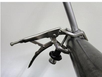
die Klemmung hält zuverlässig, selbst wenn die Rohrzange gelöst wird
