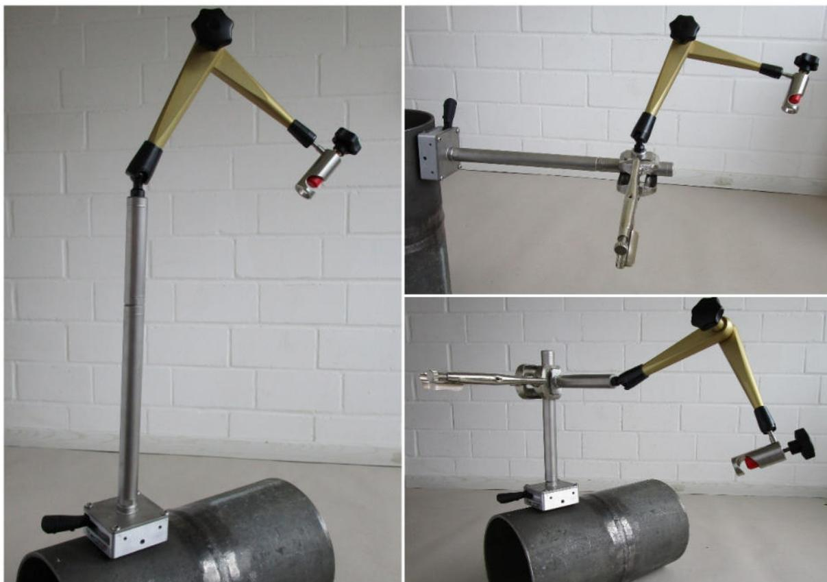
Bedienhinweise zum Hydraulik-Stativ: Die Hydraulik des Gelenkstativs entwickelt große Kräfte bereits bei relativ leichtem Anziehen des Handrads. Die maximale Klemmkraft von ca. 7 kg wird erreicht, wenn beide Gelenkkugeln ölfrei und trocken sind.
